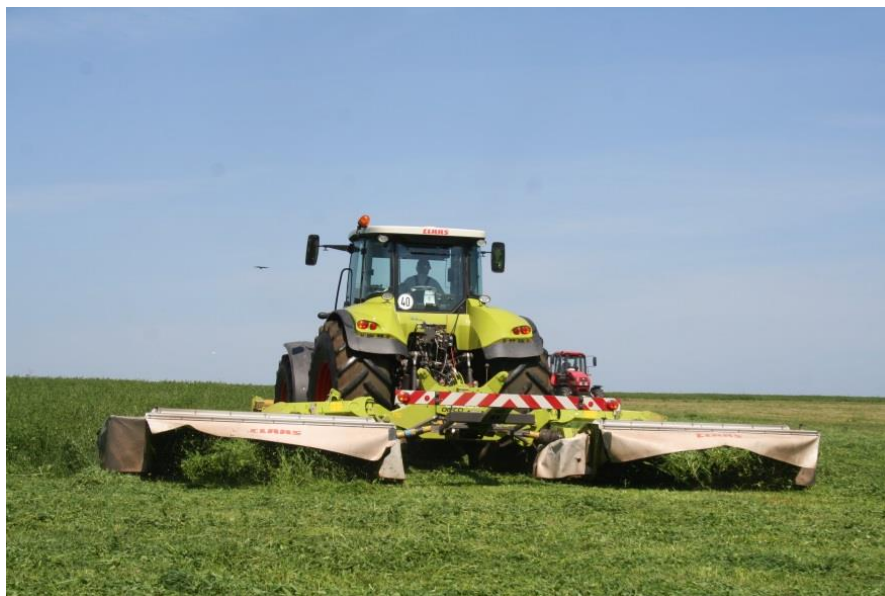
Рис.1. Косилка комбинированная дисковая DISCO 8400 фирмы CLAAS
