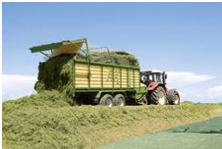
Рис. 5. Полуприцеп-подборщик фирмы KRONE
