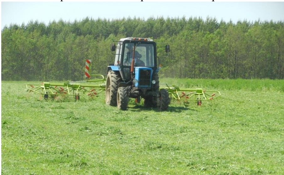
Рис. 2. Ворошилка VOLTO фирмы CLAAS
