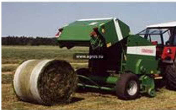
Рис.7. Рулонный пресс-подборщик фирмы SIPMA
