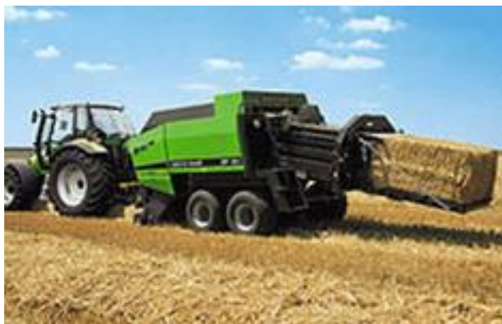
Рис.6. Пресс-подборщик высокого давления, формирующий крупно-габаритные прямоугольные тюки
