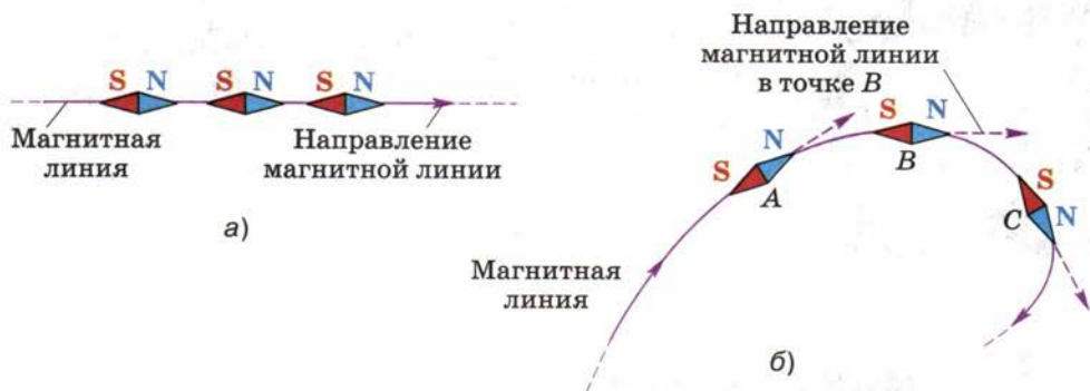
Рис. 86. В любой точке магнитной линии касательная к ней совпадает с осью магнитной стрелки, помещённой в эту точку
