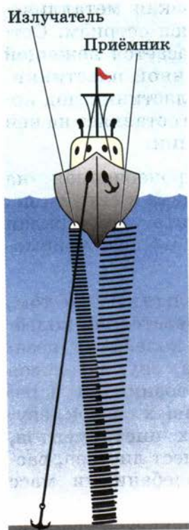
Рис. 78. Использование ультразвуковых колебаний для измерения глубины моря
