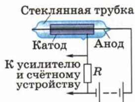
Рис. 159. Схема устройства счётчика Гейгера
