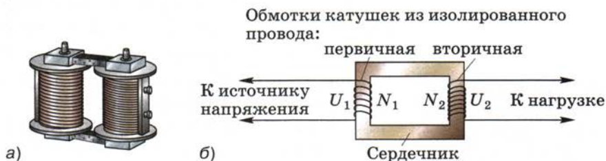
Рис. 134. Внешний вид и схема устройства повышающего трансформатора
