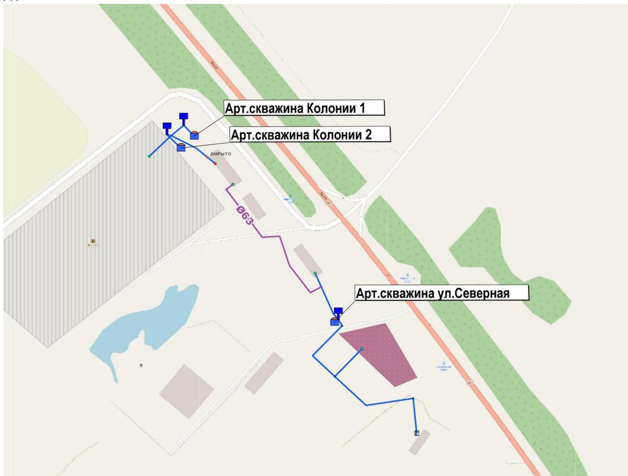
Рис. 4.2. Схема перспективного водоснабжения ул.Северная г.Цивильск
