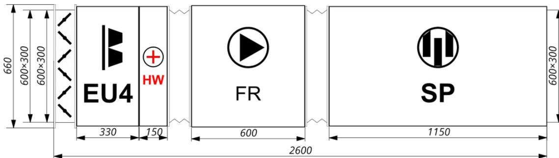
Установка: LM DUCT Q 60-30 /V.1/EG.4/HW.2/G.1/FP.C28.007A2/G.1/SP.10
