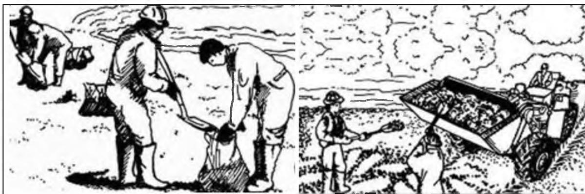
Рисунок 2 – Ликвидация разлива нефтепродукта искробезопасным шанцевым инструментом
