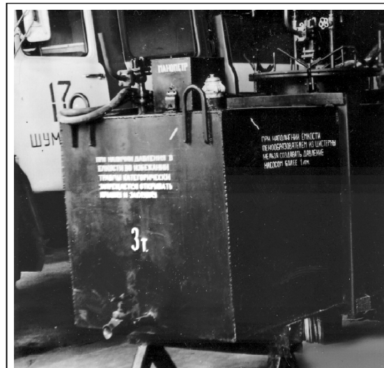
Вспомогательная система (аппарат) для заправки пенобаков пожарных автомобилей пенообразователем под давлением из посторонних емкостей и путем всасывания штатным насосом пожарного автомобиля для пениной атаки на пожарах.
