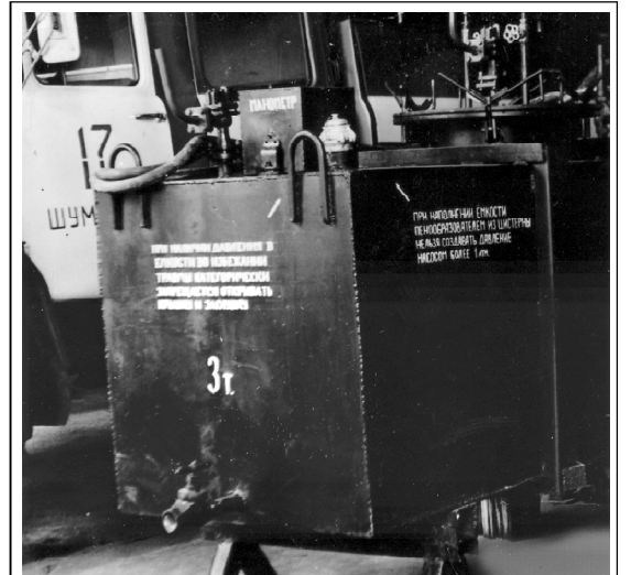
Вспомогательная система (аппарат) для заправки пенобаков пожарных автомобилей пенообразователем под давлением из посторонних емкостей и путем всасывания штатным насосом пожарного автомобиля для пенной атаки на пожарах.
