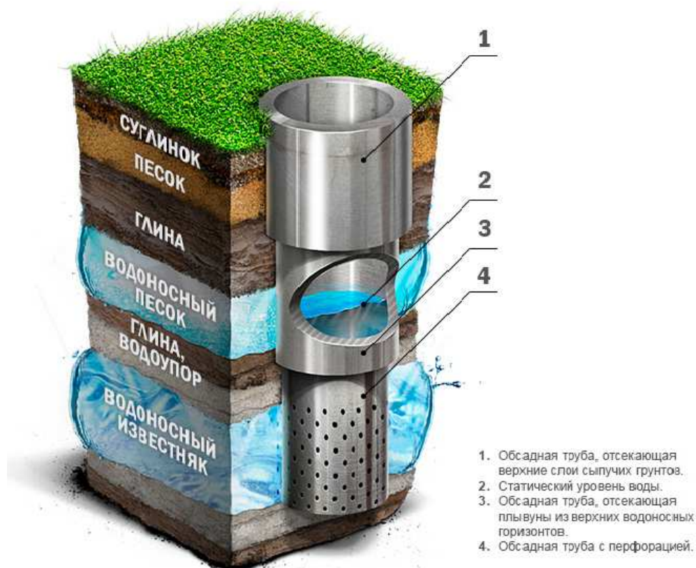
Рис. 4.1. Конструкция артезианской скважины
