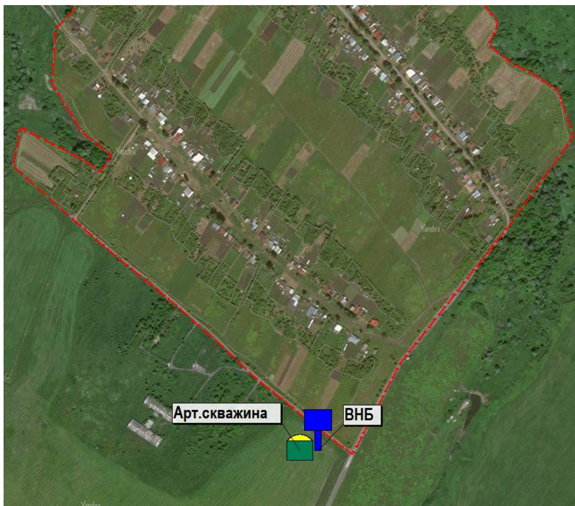
Рис. 3.7. Предполагаемое место строительства нового источника водоснабжения в юго-восточной части села
