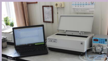
Анализатор жидкости «Ф.ЛЮОРАТ-02-5М» Определение нефтепродуктов в воде, нефтепродуктов в почве
