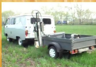
Автоматический почвенный пробоотборник NIETFELD H 2005. Предназначен для отбора проб методом сверления
