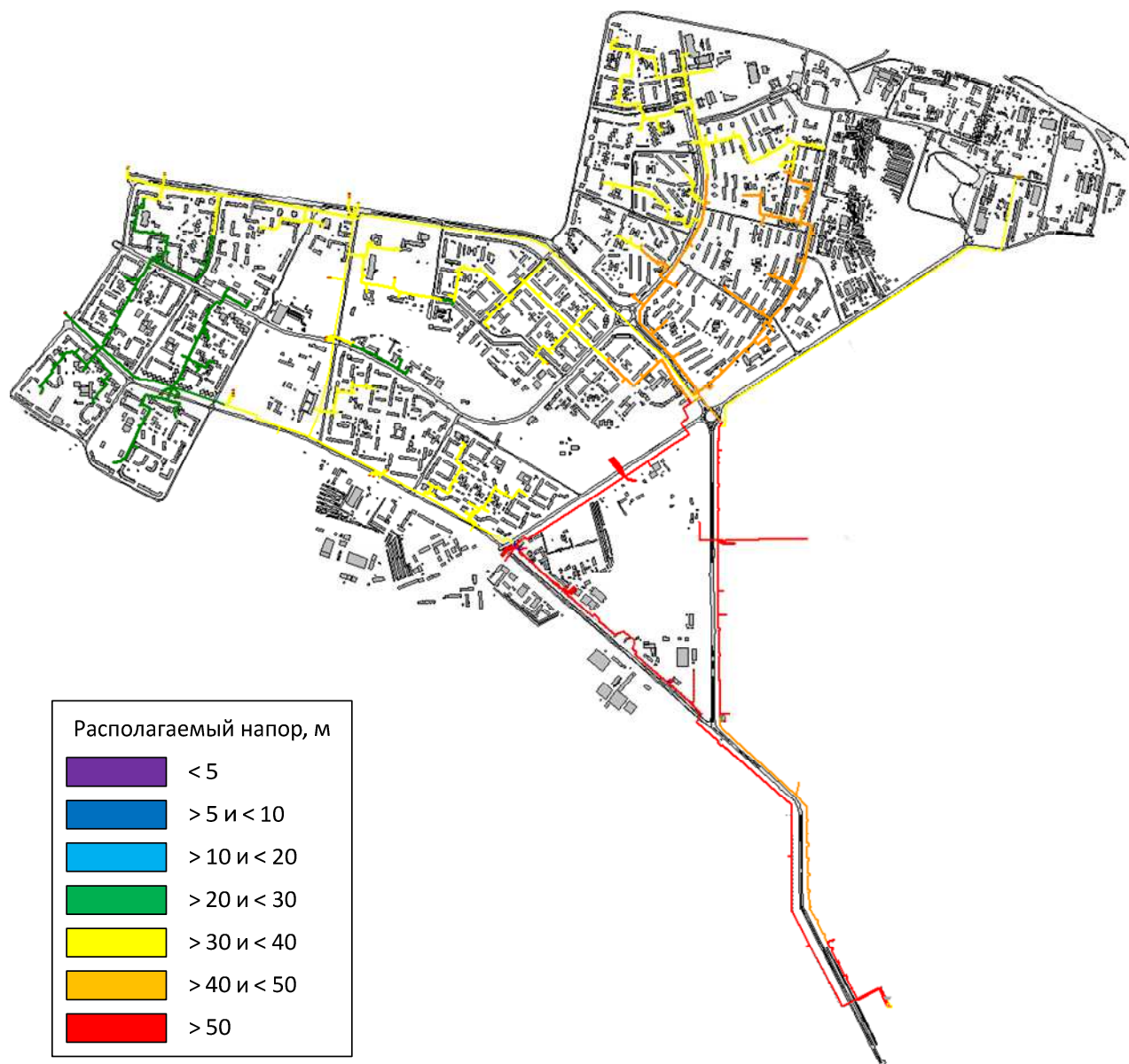
Рис. 5.3. Ожидаемый располагаемый напор теплоносителя в тепловых сетях г. Новочебоксарска, с учетом проведения мероприятий по строительству новых и реконструкции существующих трубопроводов и перспективных тепловых нагрузок по состоянию на конец 2027 года
