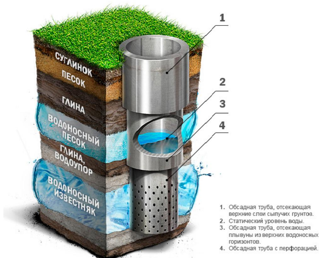
Рис. 4.1. Конструкция артезианской скважины
